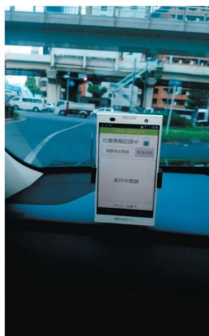
自治体が保有する道路パトロール車（写真左）や公用車に設置したスマートフォン（写真右）で加速度や位置情報を収集し、富士通のクラウドデータセンターに送信。
